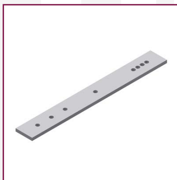
Befestigungsteil, Größe 1 für Schutzrohrinstallation an Profilträgern, Länge 245 mm, aus Flachstahl 30x5 mm, an der Körnung abzubiegen
