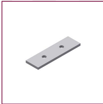
Abstandshalter 951 Befestigungsteil für Rohre Ø 12 mm, Länge 85 mm, aus Bandstahl 25 x 4 mm
