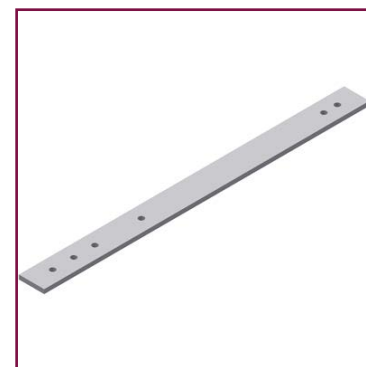
Befestigungsteil, Größe 6 für Schutzrohrinstallation an Profilträgern, Länge 385 mm, aus Flachstahl 30x5 mm, an der Körnung abzubiegen
