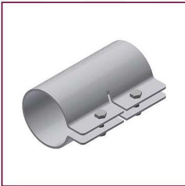
Verbindungsschelle DN65 Länge 145 mm, für Rohraußendurchmesser 76,1 mm, aus Stahlblech 2,5 mm dick, mit 2 Sechskantschrauben M8x25, 2 Sechskantmuttern M8, 2 Federringen verzinkt
