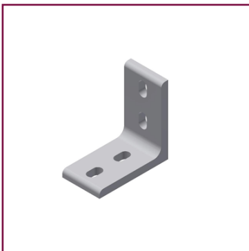
Haltewinkel Nr. 999, Größe 65 Befestigungsteil für U-Stahl 65 mm, Abmessung 120x65x120 mm, Stärke 13 mm, mit 4 Langlöchern 14x25 mm
