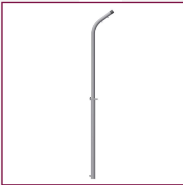
Leuchtenständer DN65 umklappbar aus Gewinderohr (Unterteil DN65x1.300 mm und Oberteil DN50x1.580 mm), Rohr ist geeignet zum Einziehen von Kabeln, mit Gewinde R 2“ durch Kappe geschützt
