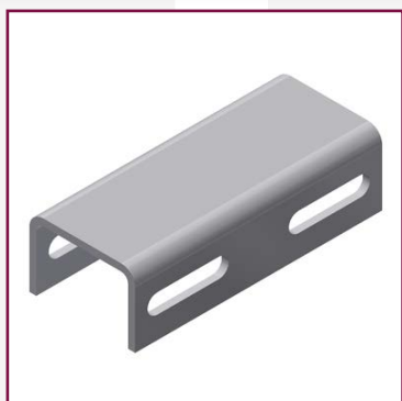
Abstandshalter für Leuchtenständer am Geländer DN32, in U-Form 140x60x40 mm
