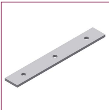
Abstandshalter 953 Befestigungsteil für Rohre Ø 12 mm, Länge 175 mm, aus Bandstahl 25 x 4 mm
