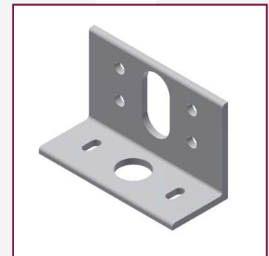
Haltewinkel für Leuchtenfuß bzw. Leuchtenständer am Geländer nach WN 72-28, aus ungleichschenkeligem Winkelstahl 150x100x10 mm
