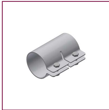
Verbindungsschelle DN32 Länge 105 mm, für Rohraußendurchmesser 42 mm, aus Stahlblech 2,5 mm dick, mit 2 Sechskantschrauben M8x25, 2 Sechskantmuttern M8, 2 Federringen Ø 8,1 mm
