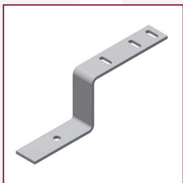
Befestigungsteil Universalteil zum Befestigen von Abzweigkästen bzw. Verbindungsboxen an der Fußleiste von Gitterrostbühnen, aus Bandstahl 30x4 mm
