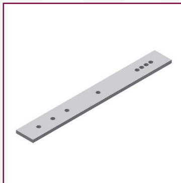
Befestigungsteil, Größe 1 für Schutzrohrinstallation an Profilträgern, Länge 245 mm, aus Flachstahl 30×5 mm, an der Körnung abzubiegen
