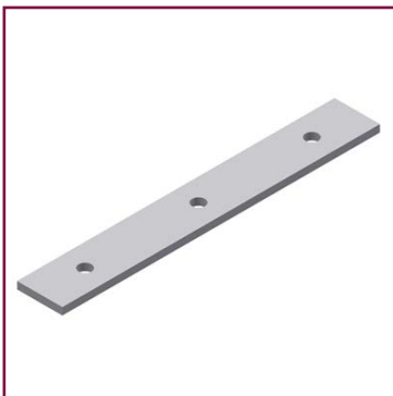
Abstandshalter 953 Befestigungsteil für Rohre Ø 12 mm, Länge 175 mm, aus Bandstahl 25×4 mm
