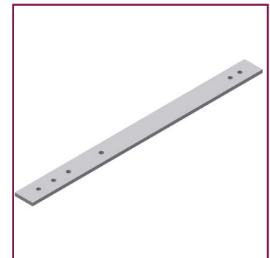
Befestigungsteil, Größe 6 für Schutzrohrinstallation an Profilträgern, Länge 385 mm, aus Flachstahl 30×5 mm, an der Körnung abzubiegen
