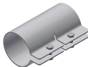
Verbindungsschelle DN65 Länge 145 mm, für Rohraußendurchmesser 76,1 mm, aus Stahlblech 2,5 mm dick, mit 2 Sechskantschrauben M8×25, 2 Sechskantmuttern M8, 2 Federringen verzinkt
