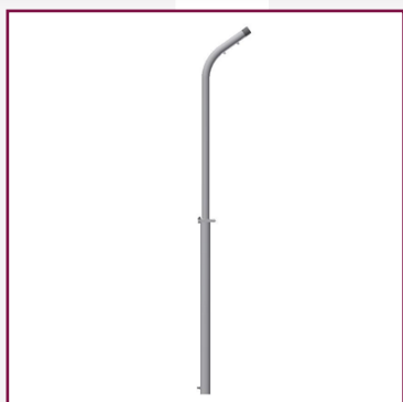
Leuchtenständer DN65 umklappbar aus Gewinderohr (Unterteil DN65×1.300 mm und Oberteil DN50×1.580 mm), Rohr ist geeignet zum Einziehen von Kabeln, mit Gewinde R 2“ durch Kappe geschützt
