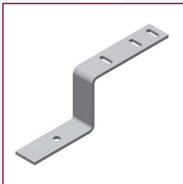
Befestigungsteil Universalteil zum Befestigen von Abzweigkästen bzw. Verbindungsboxen an der Fußleiste von Gitterrostbühnen, aus Bandstahl 30×4 mm
