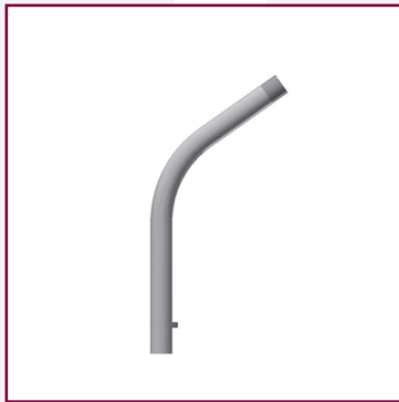
Leuchtausleger DN50 aus Gewinderohr DN50×920 mm, Gewinde R 2“, durch Rohrschutzkappe geschützt, Rohr ist geeignet zum Einziehen von Kabeln
