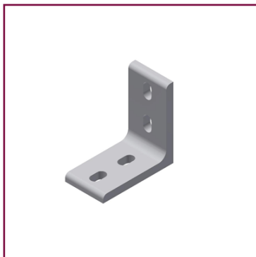
Haltewinkel Nr. 999, Größe 65 Befestigungsteil für U-Stahl 65 mm, Abmessung 120×65×120 mm, Stärke 13 mm, mit 4 Langlöchern 14×25 mm
